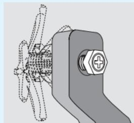
水回りのご使用には、防水パッキンを樹脂キャップに貼付け、さらにネジ穴にシリコンで十分にコーキングしてください。
